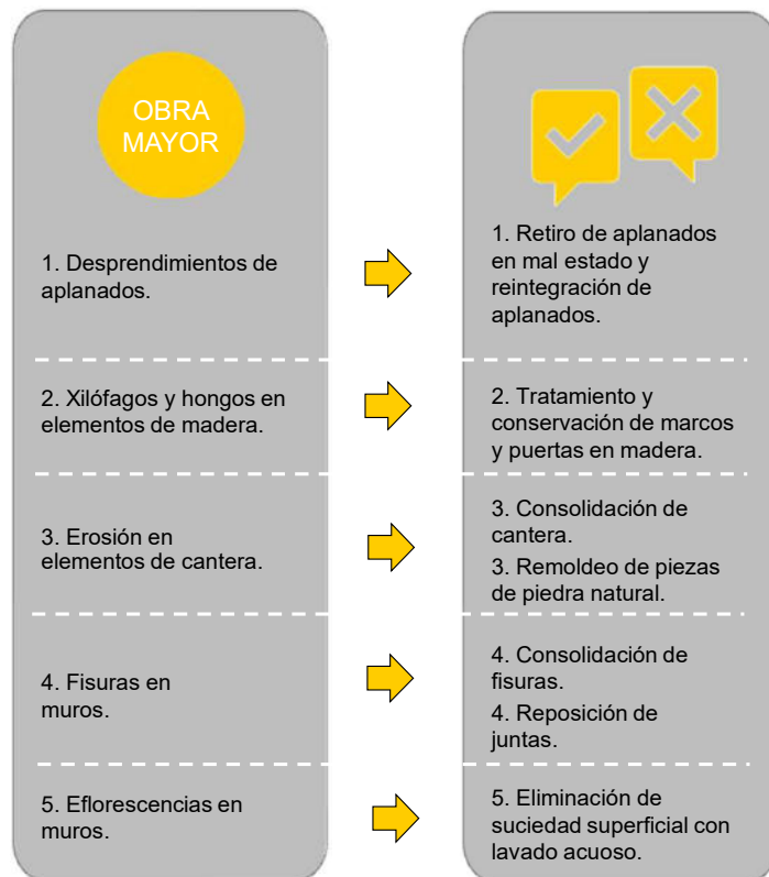
Figura 32.- Deterioros y actividades a ejecutar consideradas obra mayor.
