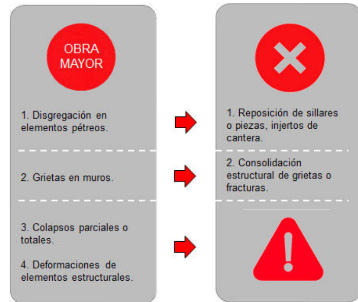
Figura 33.- Deterioros y actividades a ejecutar consideradas obra mayor
