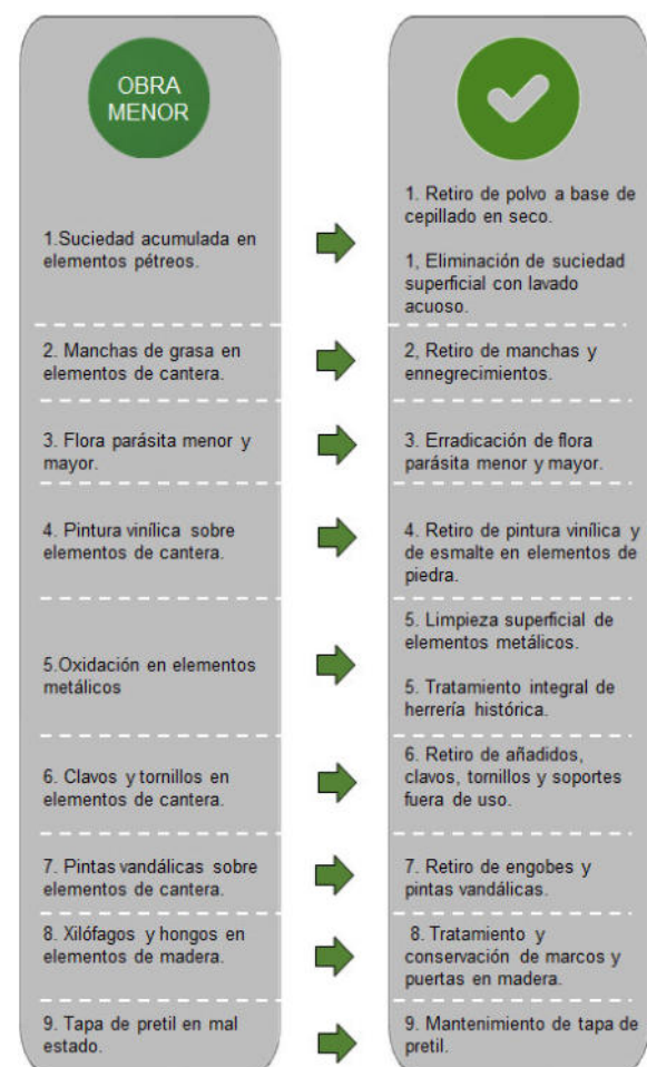
Figura 31.- Deterioros y actividades a ejecutar consideradas obra menor.
