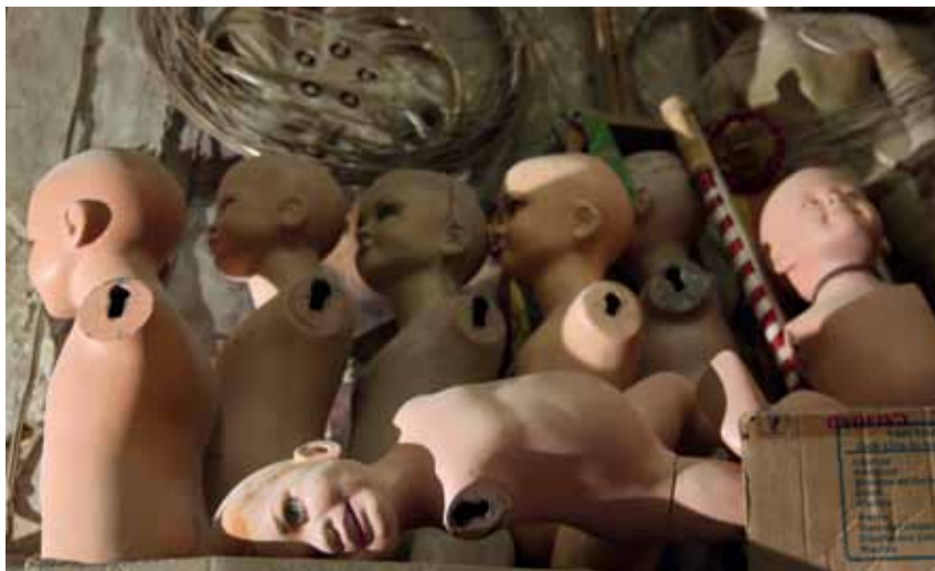
LOS MANIQUÉS SE ELABORAN CON RESINA Y FIBRA DE VIDRIO.
