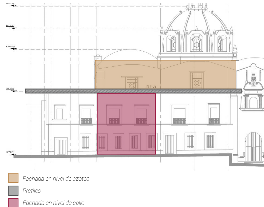
Figura 136. Fachada sur, identificando el área a intervenir
